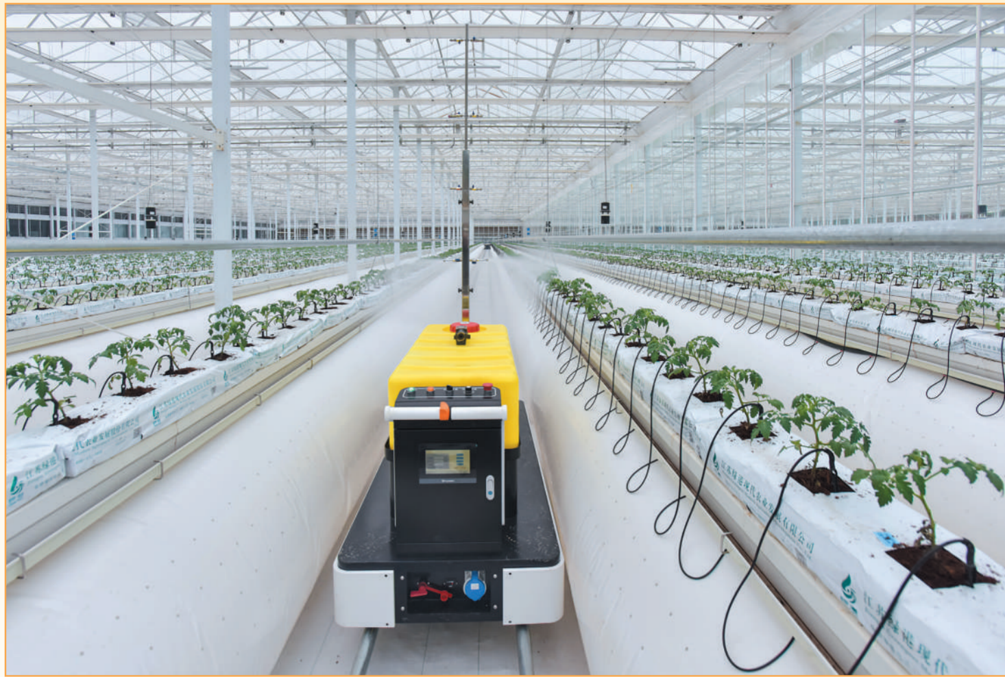
上图:湖北省竹山县宝丰镇龙井村,在五福龙井智慧农业生态园,全自动植保机在玻璃温室为番茄苗喷洒叶面肥和清水。
