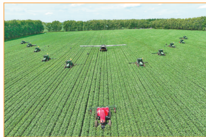
黑龙江省黑河市,北大荒集团北安分公司组织多台经过改装的智能农机,在无人驾驶状态下对作物进行中耕作业。
