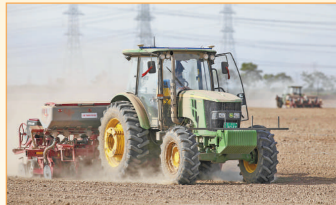
宁夏农垦集团前进农场,无人驾驶机械在北斗导航系统的辅助下播种。
